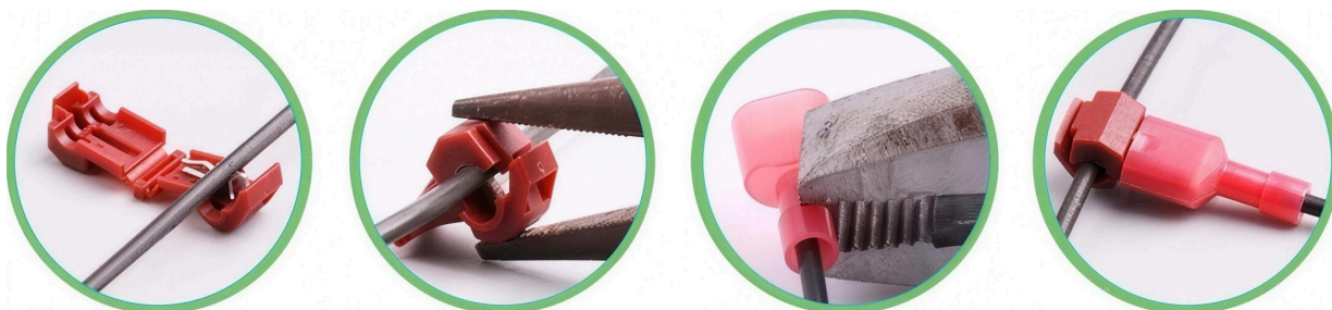
El T-tap perfora el aislante y deriva de un cable existente
