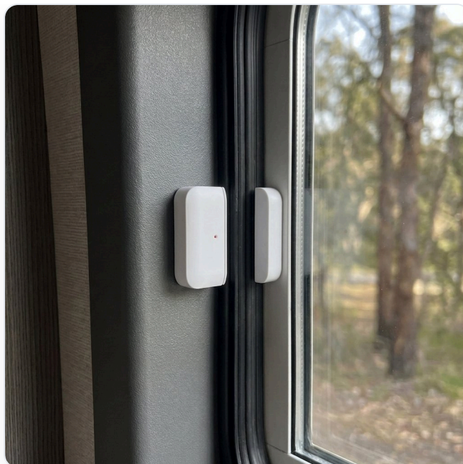
LockSense Pro en una ventana de autocaravana: emisor en la parte fija, imán en la parte móvil
