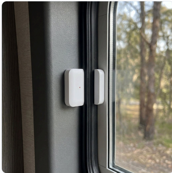
LockSense Pro an einem Wohnmobilstfenster: Sender am festen Teil, Magnet am beweglichen Teil
